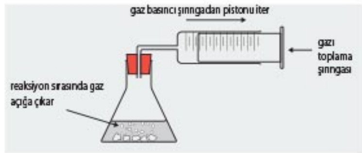
Açığa çıkan gazın hacmini ölçme vasıtasıyla tepkime hızını ölçmek için kullanılan aygıt.
